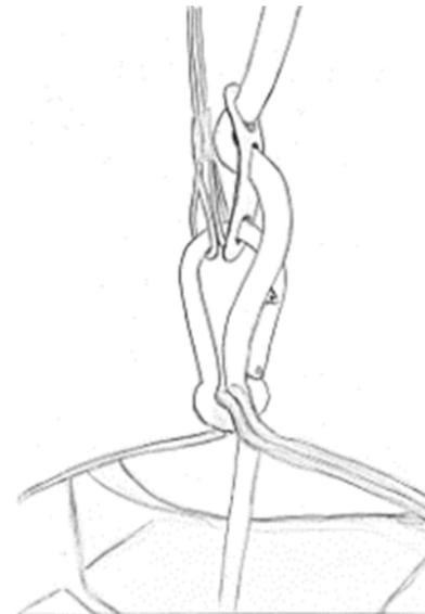
Bringen Sie die Fassung samt Leuchtmittel entsprechend der Skizze in den Lampion ein. Das Kabel wird mit der Fixierungs-Lasche am Karabinerhaken befestigt. Es darf beim Einführen in den Karabinerhaken nicht beschädigt werden.
