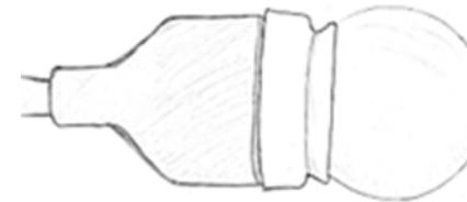
Schrauben Sie das Leuchtmittel in die Fassung. Achten Sie hierbei auf die maximale Lampenleistung und Art des Leuchtmittels. Die Dichtmanschette muss das Leuchtmittel richtig abdichten! Andernfalls setzen Sie bitte ein anderes Leuchtmittel ein.
